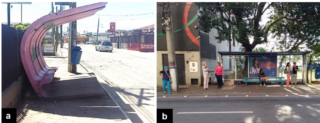
Fig. 4: Barreiras existentes nos sistemas e meios de transportes. a) Ponto de ônibus em concreto sobre o passeio impede o acesso de pessoas em cadeira de rodas ou com dificuldades de movimento, apesar da existência de ônibus acessíveis com plataformas elevatórias. b) Pontos de ônibus sem placas informativas sobre linhas e horários dificultam seu uso para todos, e a ausência de pisos táteis impede o acesso seguro ao veículo para pessoas com deficiência visual. Fonte: a) Acervo pessoal de Paty de Avila Baccin. b) Acervo pessoal de Marta Dischinger.
