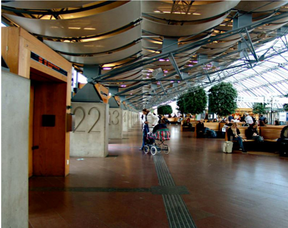
Fig. 2: Neste terminal rodoviário podem-se reconhecer as diferentes áreas de uso (espera, área de circulação, portões de acesso aos decks de ônibus identificados por números) pela disposição do mobiliário. Pisos táteis sinalizam as áreas de circulação e os acessos para cada portão de acesso aos decks de ônibus.
