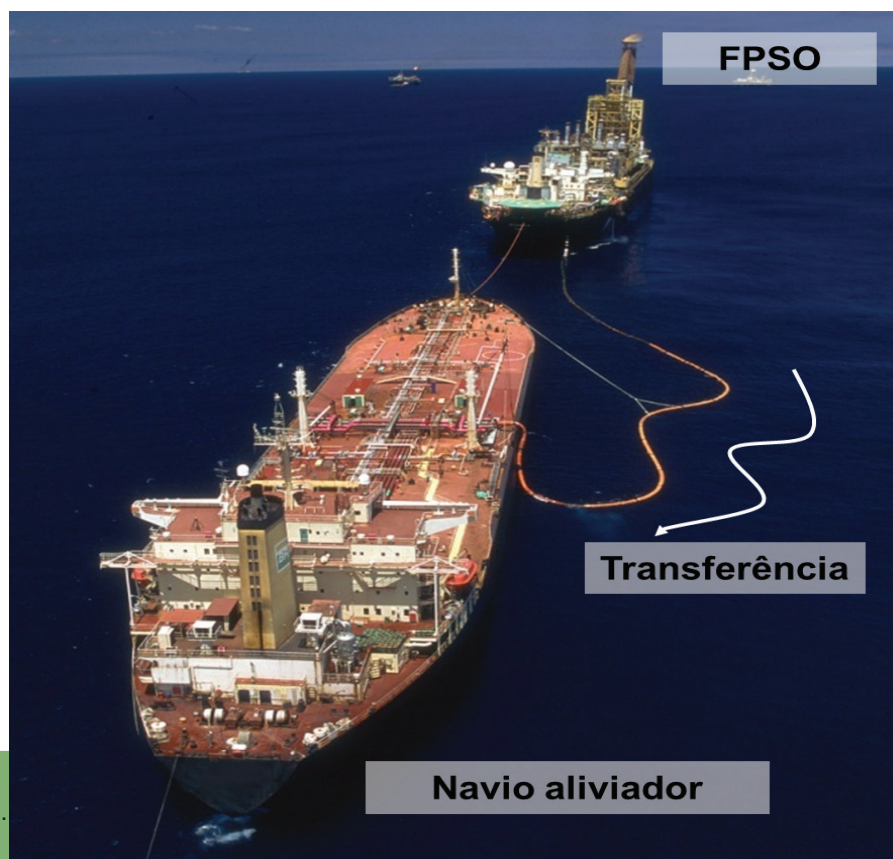
Figura 10 – Esquema de transferência de óleo ( offloading ). Fonte: PETROBRAS.
