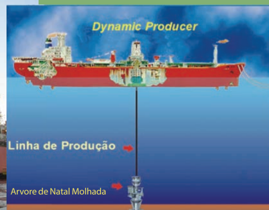
Figura 14 – Ancoragem do FPSO Dynamic Producer . Fonte: PETROBRAS
