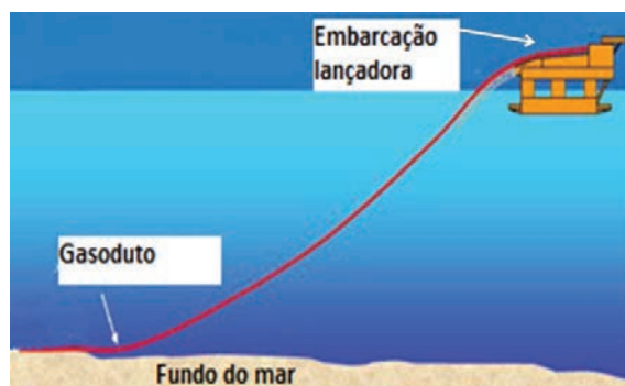
Figura 18 – Desenho esquemático de lançamento do primeiro método. Fonte: PETROBRAS
