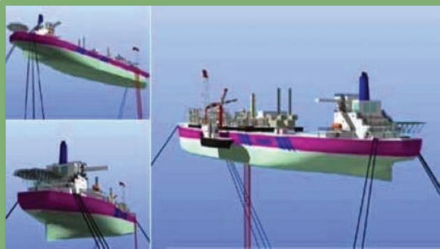
Figura 16 – Ancoragem dos FPSOs responsáveis pelos DPs. Fonte: PETROBRAS
