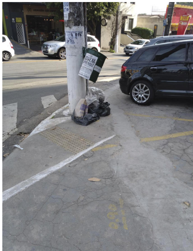
Figura 50 Exemplo de incompatibilidade e sobreposição de elementos no espaço urbano, com poste com lixeira localizado na frente da rampa para travessia viária de pedestres, além de acondicionamento de sacos com resíduos na calçada e estacionamento de veículos demarcado na calçada, compondo um trecho de difícil transposição pelo pedestre. Fonte: Cortesia de José Alberto Quintanilha.
