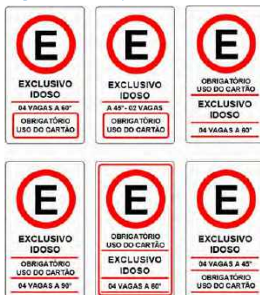
Sinalização vertical de vaga para pessoa idosa
