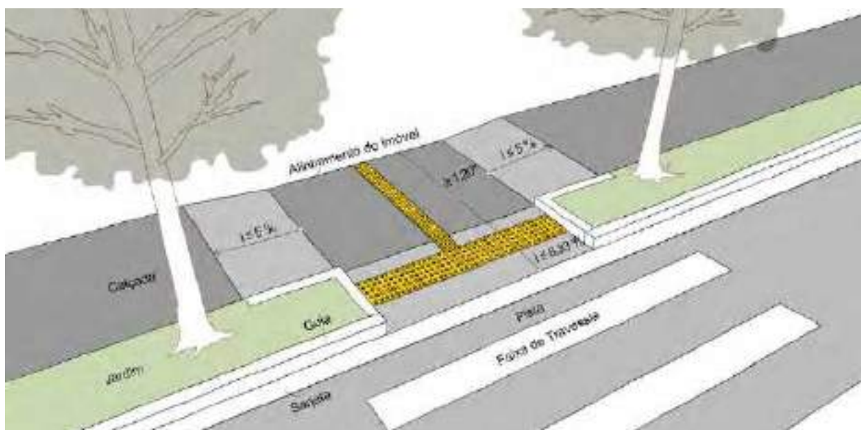
Rebaixamento TIPO C, com canteiros - exemplo 2
