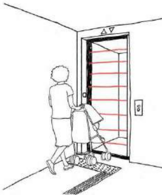
Tolerância ao erro, sensor de movimento que impede o fechamento das portas enquanto está sendo utilizado
