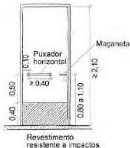
Vista interna de porta de sanitário, com reforço na parte inferior, puxador horizontal e maçaneta tipo alavanca
