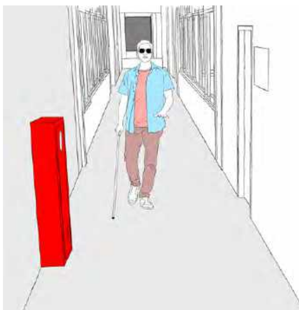
Objeto fixado em superfície vertical, sem uso de sinalização
