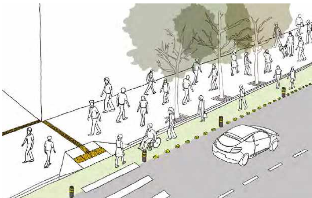
Ampliação da calçada com sinalização horizontal sobre a via
