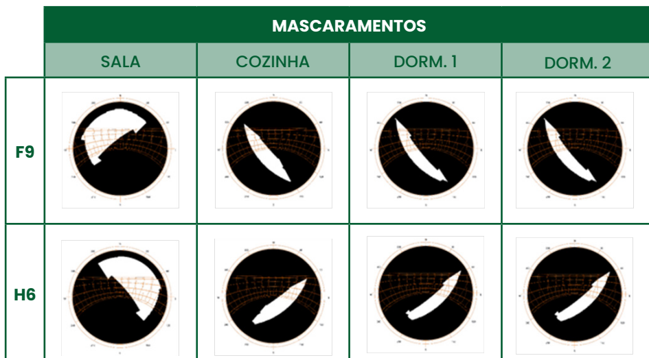
Quadro 5. Mascaramentos desenvolvidos para as amostras do empreendimento localizado em Bauru (SP).
