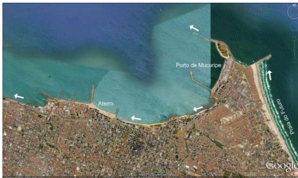
Figura 10.5 – Efeito da construção de um quebra-mar à montante do Porto de Mucuri- pe na perda das praias urbanas de Fortaleza.
