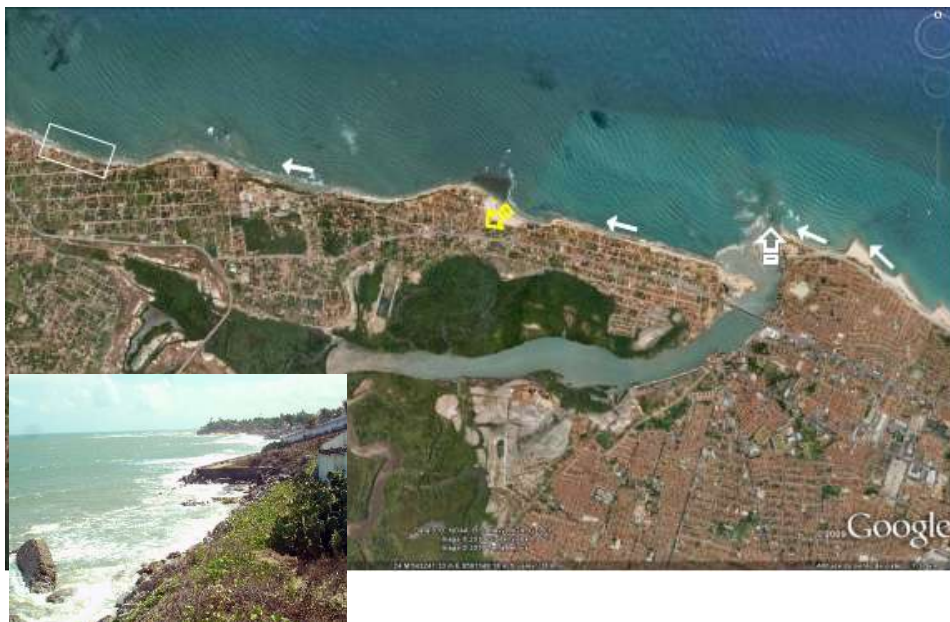
Figura 10.4 – Trecho do litoral do Ceará a noroeste de Fortaleza mostrando a direção da deriva litorânea, a retenção de sedimentos por espigões, o aporte, insuficiente, de sedimentos pelo Rio Ceará, a perda de sedimentos pelo campo de dunas e a perda da Praia do Pacheco.
