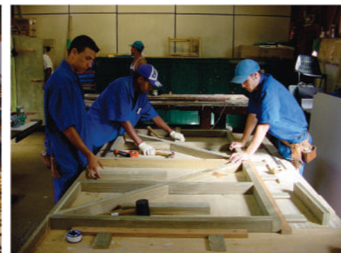
Oficina da Cooperativa de Restauro: produzindo elementos construtivos para o banco de materiais de reposição. Fonte: LIMA et. al, 2008. Foto: LIMA, 2006.
