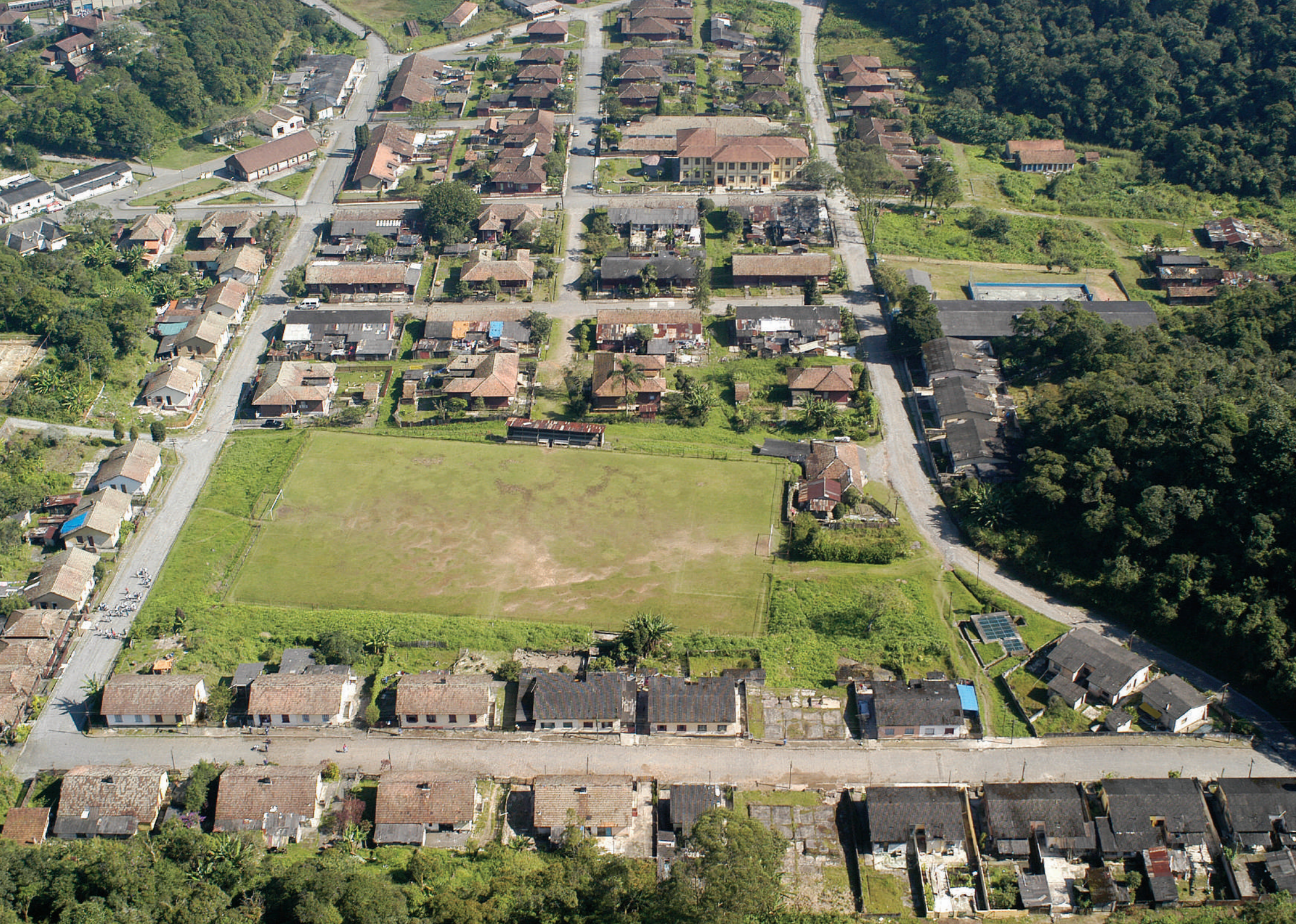
Ruas largas e retas se cruzam ortogonalmente na Vila Nova. Vias sanitárias, ao centro das quadras definem os fundos de lotes. Foto aérea de Júlio Bastos, 2008.
