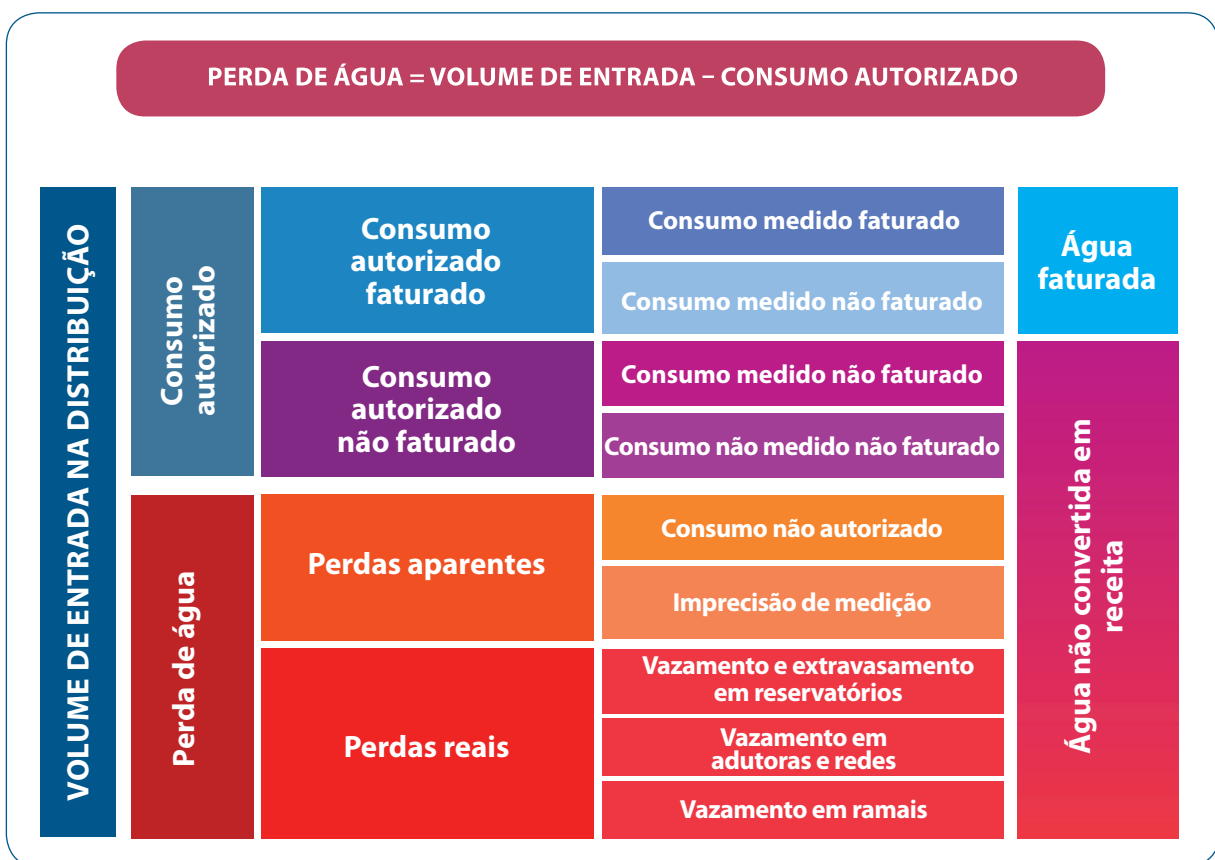
Figura 2 – Balanço Hídrico, modelo IWA, em apoio à definição do conceito de perdas de água.
