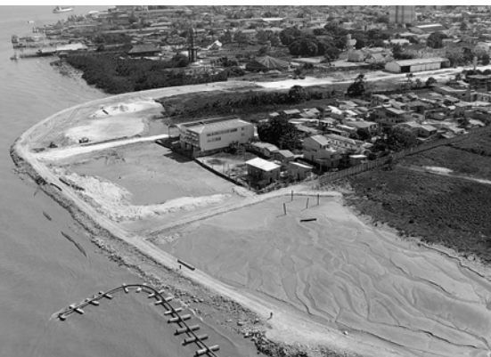
Fotos 6 e 7 - Execução do aterro hidráulico do projeto Portal da Amazônia e a obra executada, ao sul de Belém
