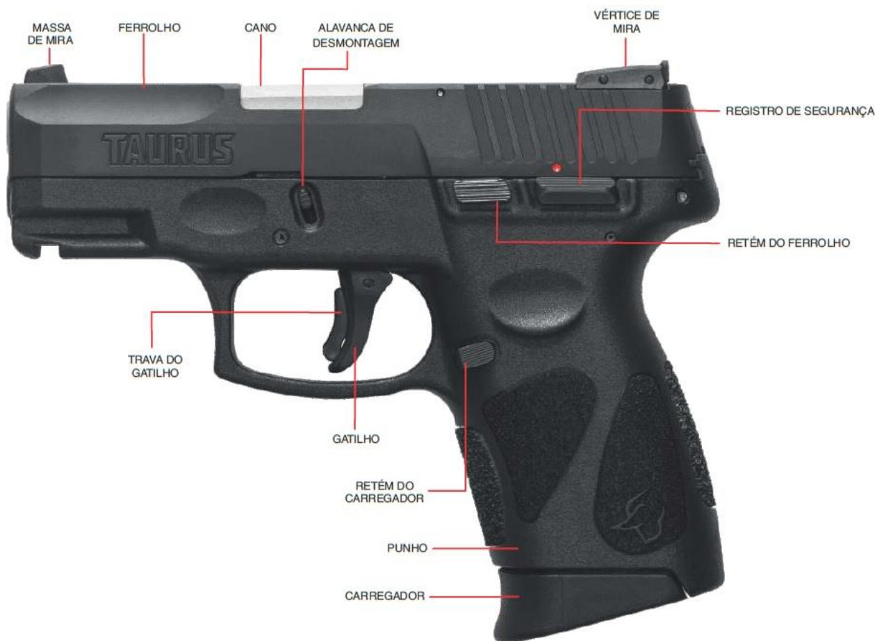
Os principais componentes de uma pistola (G2C-Taurus)
